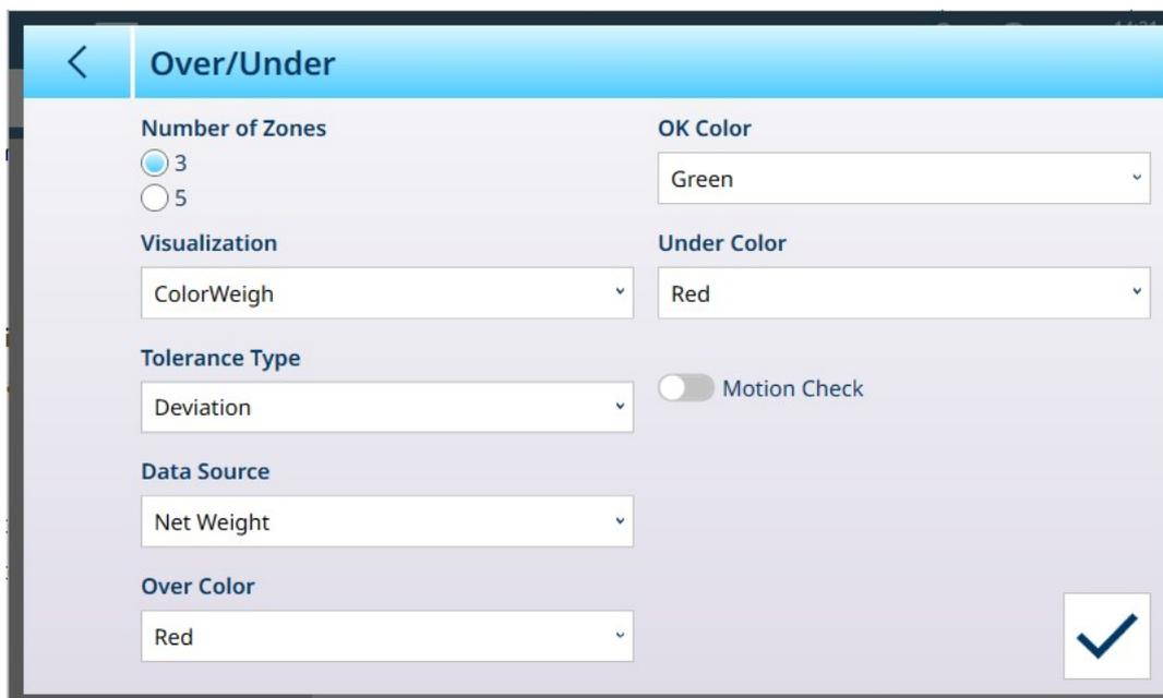
Figura 96: Schermata di configurazione di Sopra/Sotto, 3 zone, visualizzazione ColorWeigh
