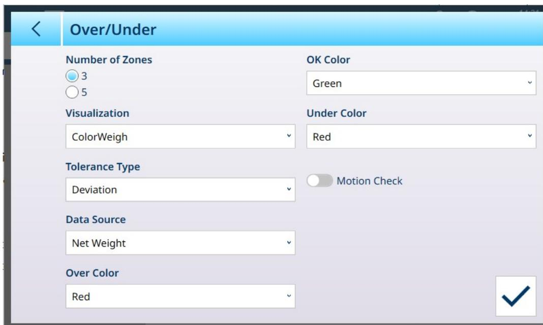
Figura 112: Schermata di configurazione di Sopra/Sotto, 3 zone, visualizzazione ColorWeigh
