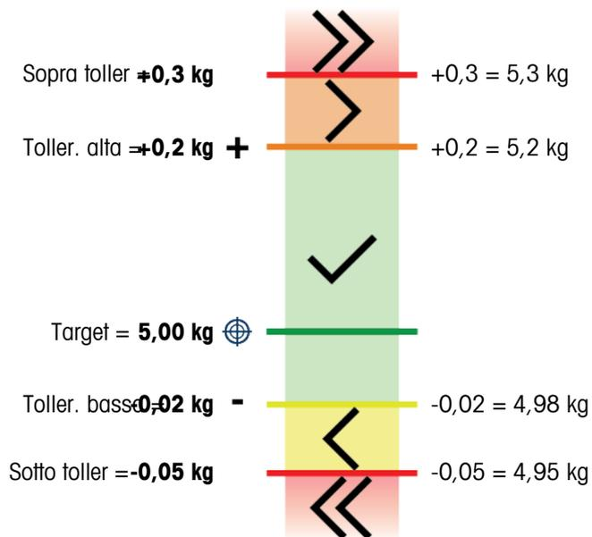
Figura 79: 5 zone, target di 5 kg, deviazione dal target
